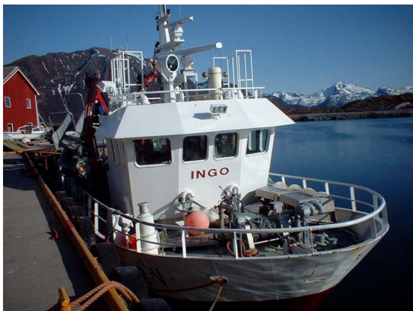
Bilde 6: En ny 59 fots kystfiskebåt bygget under grensa på 80 GT
