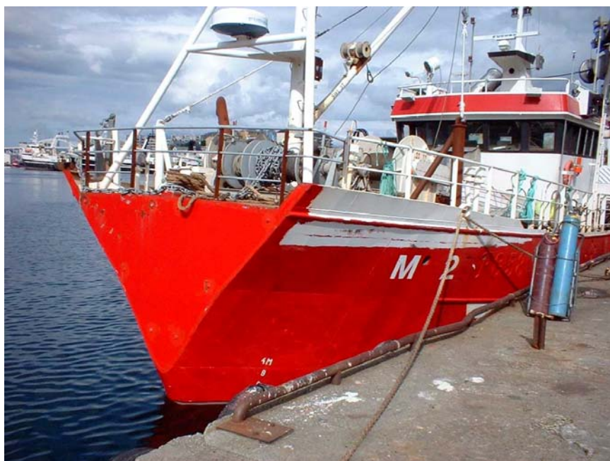
Bilde 1: Fiskebåt med kuttet baug for deltakelse i makrellfisket med not
